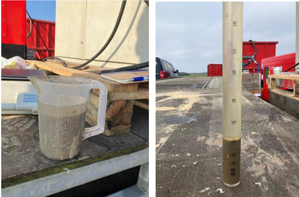
Figuur 23. Zandfractie nieuwe diepdrain Slufterweg bij aanvang (links) en na 2 dagen onttrekken (rechts)
