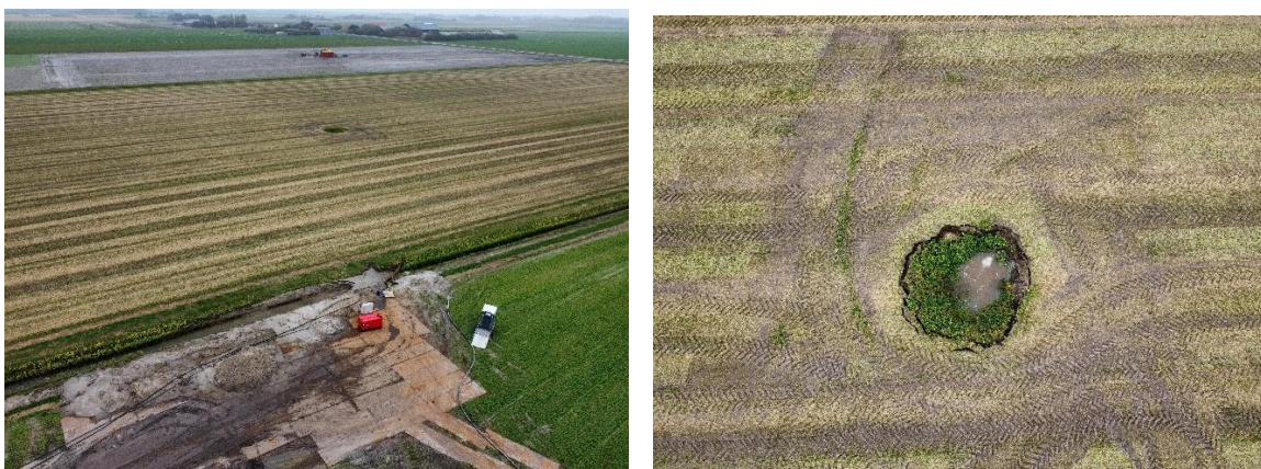
Figuur 24. Sinkhole boven het diepdraintracé
